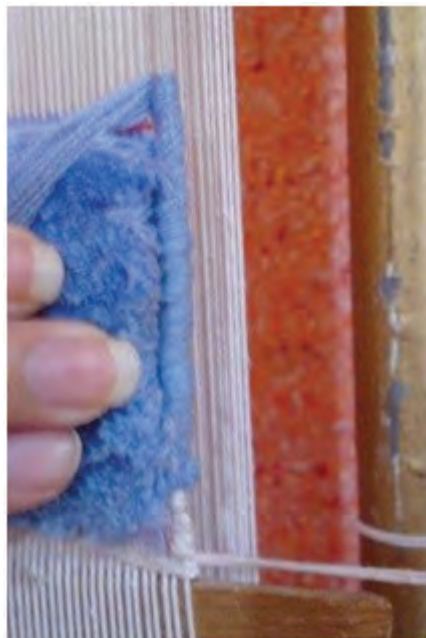
شکل ۸۱- شیرازه و شیرازه پیچی
