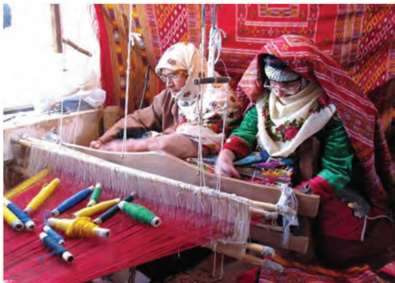
شکل ۹۲- دستگاه جاجیم بافی
