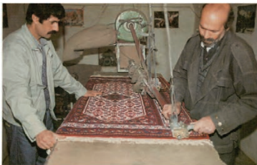
شکل ۹۴- قیچی برقی یا دستگاه پرداخت
